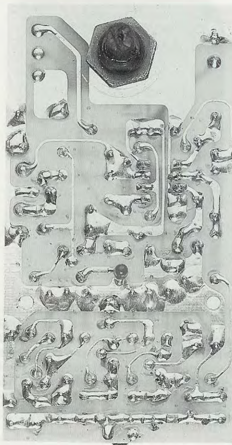
Fig.10 Lo stampato di sinistra visto dal lato delle stagnature. Su questo lato dovrete inserire il diodo led DL2, perché la testa del suo corpo dovrà fuoriuscire dal mobile. Se eseguirete delle ottime stagnature il circuito funzionerà all'istante.
