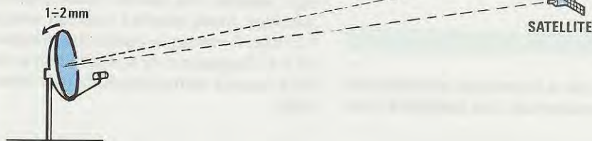
Fig.1 Poiché il satellite si trova a 36.000 Km di distanza dalla Terra, per poterlo "centrare" bisogna muovere la parabola sia in orizzontale sia in verticale di pochi millimetri, diversamente non sarà possibile trovarlo.
