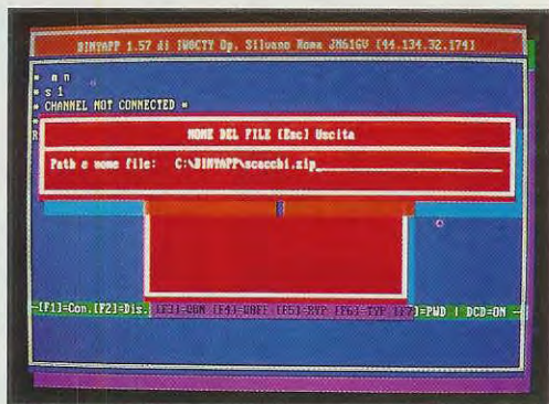
Fig.15 Se volete trasmettere dei files di programma in formato YAPP apparirà questa finestra dentro la quale dovreste scrivere l'intero nome del file.
